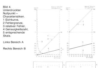
Während der relative Fehler im Bereich A zufolge der Anzeigeunsicherheit der Federwaage von ±2 niemals unter 2% sinken kann, verringert sich dieser Fehler im Bereich B bis auf einen Wert von ± 1 %. Dies bedeutet für den zweiten Bereich eine scheinbare Verbesserung der Güteklasse von 2 auf 1, obwohl die Güteklasse des Federmechanismus nach wie vor der Güteklasse 2 angehört.
