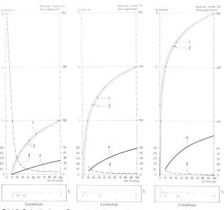
Bild 6. Substitution – Charakteristiken. 1 Eichkurve (Extinktion), 2 Fehlergrenze (Extinktion), 3 relativer Fehler (%), 4 Genauigkeitszahl, 5 entsprechende Skala.
