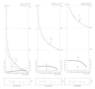
Bild 5. Unterdrückter Nullpunkt – Charakteristiken. 1 Eichkurve (Extinktion), 2 Fehlergrenze (Extinktion), 3 relativer Fehler (%), 4 Genauigkeitszahl, 5 entsprechende Skala.
