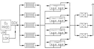
Bild 2. Fliessdiagramm der Ozonanlage von Los Angeles. O<sub>3</sub>-Produktion 187,5 kg/h; O<sub>3</sub>-Konzentration 6 Gewichtsprozent; Kühlwassertemperatur 28°C
