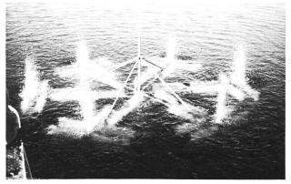
Bild 5. Ein Diffusor mit 6 m Durchmesser hat 42 Filterkerzen aus gesintertem Stahl, welche Blasen von weniger als 1 mm Durchmesser erzeugen. Zusätzlich sind 3 bis 6 Düsen für den grobblasigen Betrieb installiert, die bei einem landseitigen Druck von mehr als 7 bar ansprechen. Im Sommer können so 5 bis 40 kg  $\rm O_2/h$  ausschliesslich feinblasig, im Winter 50 bis 100 m³ Druckluft/h überwiegend grobblasig (wie Foto) eingetragen werden
