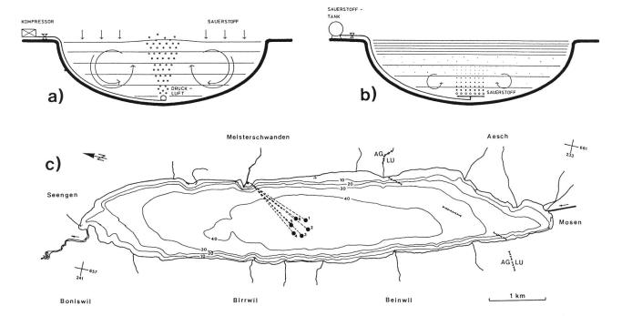
Bild 3. Prinzip und Anordnung der Belüftung im Hallwilersee.
