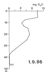
Bild 7. Typische Sauerstoffprofile im Hallwilersee vor und nach Beginn der see-internen Massnahmen (1. Zwangszirkulation, Dezember 1985 bis Mai 1986, Testbetrieb Tiefenwasserbelüftung, September 1986 bis November 1986, 2. Zwangszirkulation, November 1986 bis Mai 1987).
