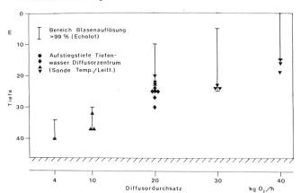
Bild 12. Aufstiegshöhe der Sauerstoffblasen und des kalten Tiefenwassers über dem Diffusor bei verschiedenen Gasdurchsätzen im Hallwilersen
