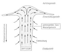
Bild 11. Schematische Darstellung des durch den aufsteigenden Gasstrom induzierten Wassertransports.
