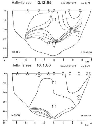
Bild 8. Sauerstoffverteilung vertikal und in der Längsachse des Sees. Die Linien (Isopleten) verbinden die Orte gleicher Sauerstoffkonzentration im See. Pfeile markieren den Bereich der Eintragstellen.
