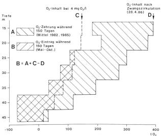
Bild 10. Abschätzung des erforderlichen Sauerstoffeintrages durch die Tiefenwasserbelüftung.
