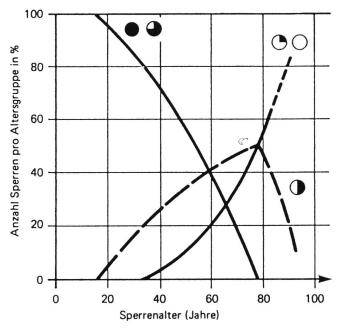
Bild 2. Sperrenzustand in Funktion von Sperrenalter und Sperrenanzahl; Signaturen siehe Tabelle 1.
