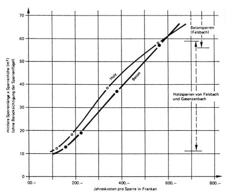
Bild 4. Sperrenjahreskosten in Funktion der Sperrengrösse (= mittlere Sperrenlänge mal Sperrenhöhe) aus volkswirtschaftlicher Sicht.
