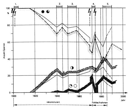
Bild 3. Gemittelter Gesamtzustand des Holzkasten-Sperrenverbaues von Gams zwischen 1901 und 1990. Signaturen siehe Tabelle 1. Der Zustandsverlauf zwischen 1901 bis 1972 wurde mit Hilfe von Bild 2 rekonstruiert, derjenige von 1973 bis 1985 basiert auf Feldaufnahmen, und die späteren Jahre wurden wiederum konstruiert. Die konstruierten Teile der Darstellung sind als genereller Hinweis zu betrachten.
