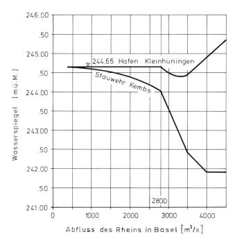
Bild 2. Auszug aus einem Regulierreglement mit vorgeschriebenen Wasserständen (Stauregelung beim Kraftwerk Kembs am Rhein).
