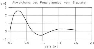
Bild 9. Sprungantwort des Regelkreises aufgrund des einfachen Behältermodells.
