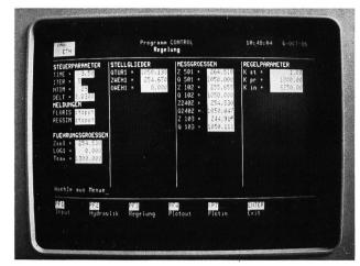
Bild 6. Tabellarische Darstellung der Resultate auf dem Bildschirm. Der Bildschirm wird laufend, das heisst nach jedem Berechnungszeitschritt, mit den aktuellen Werten überschrieben.
