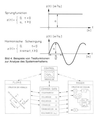
Bild 5. Schematischer Aufbau des interaktiven Programmsystems *Regel* zur numerischen Simulation von Stauregelungen bei Laufwasserkraftwerken
