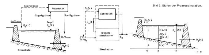
Bild 1. Prinzip der Prozesssimulation für Staustufen.
