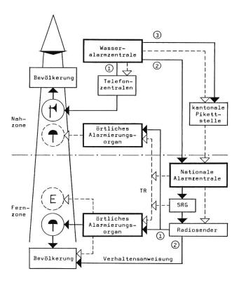
Bild 4. Das Wasseralarmsystem (1, 2, 3: Reihenfolge der Handlungen).
