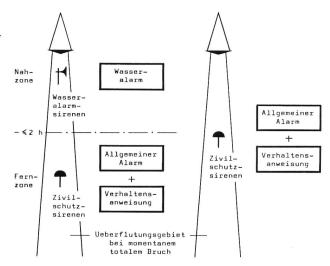
Bild 3. Das Konzept für die Alarmierung der Bevölkerung. Links für grössere Stauanlagen, rechts für kleinere Stauanlagen.
