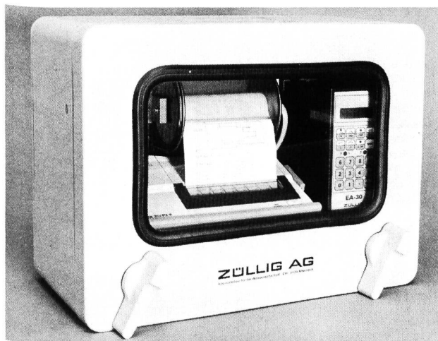
Bild 1. Mobiler Venturi zur temporären Abwassermengenmessung.
