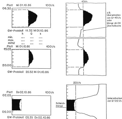
setzt und durch aufblasbare Schläuche abgedichtet. Er enthält zur Wassermengenmessung ein fest montiertes batteriegespeistes Referenzecholot und dient auch der exakten Erfassung von Schleichmengen.
