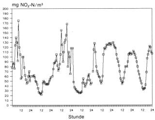
Bild 4. Tagesganglinie des Nitrits in der Woche 38/1986 in der Reppisch X-Achse Tageszeit (Stunde), Y-Achse mg  $\rm NO_2$ -N/m³.
