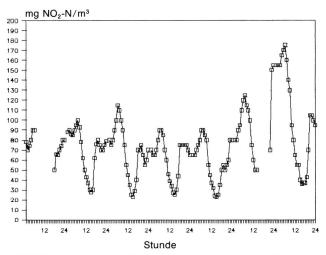
Bild 3. Tagesganglinie des Nitrits in der Woche 40/1986 in der Reppisch. X-Achse Tageszeit (Stunde), Y-Achse mg  $\rm NO_2$ -N/m³.
