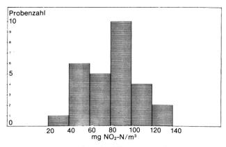
Bild 6. Statistische Verteilung der Differenzwerte zwischen Tagesmaximum und Tagesminimum der in der Reppisch gemessenen Nitritwerte in mg NO<sub>2</sub>-N/m³, 1. bis 28. September 1986. Anzahl Werte: 28; Mittelwert: 81 mg NO<sub>2</sub>-N/m³; Höchstwert: 130 mg NO<sub>2</sub>-N/m³; Tiefstwert 36 mg NO<sub>2</sub>-N/m³; Klassenbreite 20 mg NO<sub>2</sub>-N/m³.
