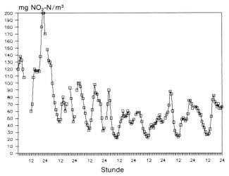
Bild 5. Tagesganglinie des Nitrits in der Woche 37/1986 in der Reppisch. X-Achse Tageszeit (Stunde), Y-Achse mg  ${\rm NO_2\text{-}N/m^3}.$
