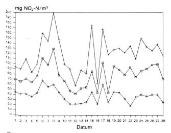
Bild 1b. Tagesmittel, Maxima und Minima von Nitrit in der Reppisch. X-Achse: Datum 1. bis 28. September 1986, Y-Achse mg NO<sub>3</sub>-N/m³.
