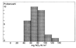
Bild 2. Statistische Verteilung der Nitrit-Tagesmittel, Reppisch, 1. bis 28. September 1986. Anzahl Werte: 28; Mittelwert: 78 mg  $NO_2$ -N/m³; Höchstwert: 130 mg  $NO_2$ -N/m³; Tiefstwert: 42 mg  $NO_2$ -N/m³; Klassenbreite 20 mg  $NO_2$ -N/m³.
