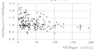
Bild 3. Vergleich zwischen den nach der modifizierten Fliesszeitformel «rational formula» abgeschätzten und den 20jährlichen Spitzenabflusswerten gemäss Frequenzanalyse.
