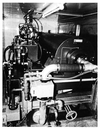
Bild 3. Dekanterzentrifuge (Foto H. Letsch, AFU GR).
