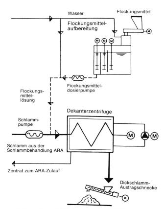
Bild 2. Fliessschema der Entwässerungsanlage (AFU GR)
