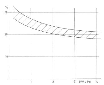
Bild 2. Kostenverlauf für Neublechung und Neuwicklung in Prozent der Kosten für einen neuen Generator über der Leistung pro Pol.
