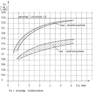
AR = resultierende Wärmeleitzahl , einschliesslich einseitiger Luftschicht
