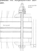
Bild 7. Verbindung von Blechpaket zu Gehäuse.
