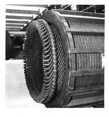
Bild 4, links. Nutfüllung mit Doppelschrägkeil.
