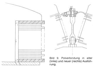
Bild 8. Hinterlüftung der Polspule (Thermosiphon-Kühlung).
