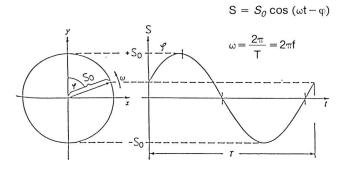
Une vibration, si complexe soit-elle, peut toujours être ramenée à cette forme élémentaire par une expression mathématique adéquate (série de Fourrier par exemple). Les paramètres fondamentaux sont l'amplitude  $S_o$ , la fréquence f, la pulsation ou fréquence angulaire  $\omega$ , et l'angle de phase  $\varphi$  au temps t=0.
