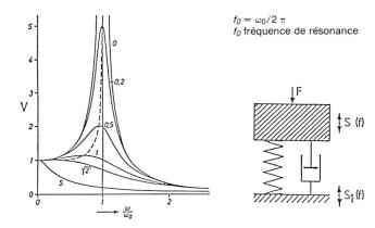
Figure 2. Amplification à fréquence propre.
