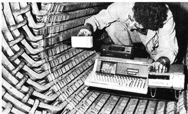
Figure 5. Le bobinage statorique vibre à la fréquence double du réseau lorsque le blocage mécanique dans les encoches est insuffisant. Ceci à pour conséquence une dégradation de l'isolation. Pour cette raison un contrôle de calage du bobinage à intervalles réguliers s'impose. Une nouvelle méthode, basée sur une mesure spéciale des vibrations, permet de réaliser ce contrôle de manière fiable, l'influence de l'opérateur étant éliminée. (Photo BBC Brown Boveri)
