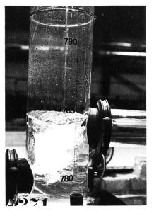
Figures 6 et 7. Mouvement tourbillonnaire entraînant de l'air dans la conduite forcée. *Q<sub>Ptattensprung</sub>* = 19 à 21 m³/s.
