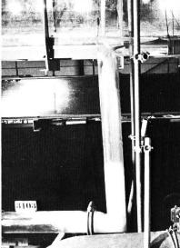
Bild 3. Obere und untere Tunnels und Stollen bei Bristen. Lufteintrag bei einem Abfluss von  $Q = 10 \text{ m}^3/\text{s}$ .
