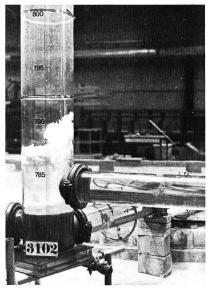
Figures 8 et 9. Poches d'air dans la galerie inférieure de Bristen et «geysers» dans la chambre d'équilibre.  $Q_{Ptattensprung}=21~{\rm m}^3/{\rm s};~5< Q_{Bristen}<10.$
