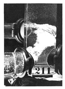
Bilder 6 und 7. Lufteintragende Wirbel bei einem Abfluss von  $Q_{Ptaffensprung} = 19$  bis 21  $m^3/s$ .
