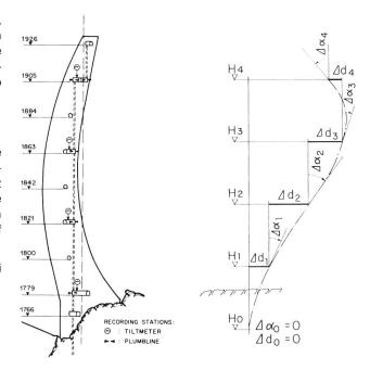
▲ Bild 4. Hauptschnitt der Staumauer Emosson mit den Positionen der Tilt-Sensoren und den Pendelmessstellen.
