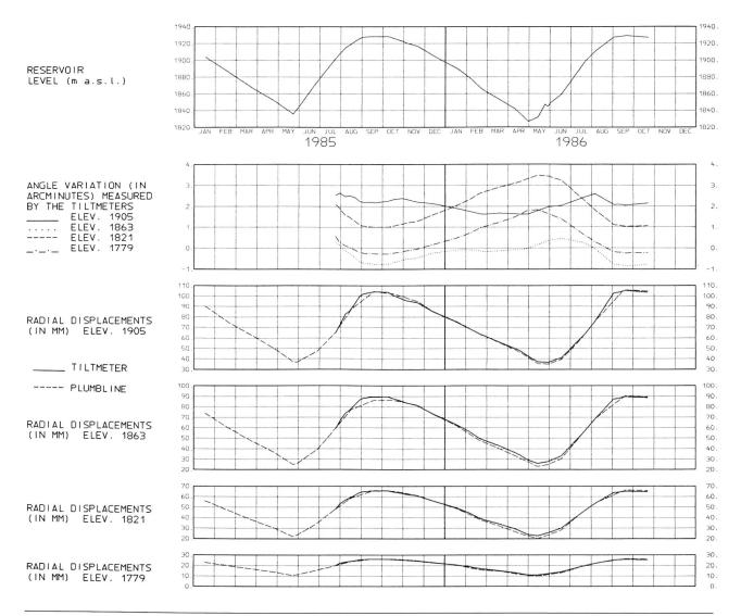
Die gesamte Horizontalverschiebung im Punkt  $H_i$  wird gefunden durch Integration der einzelnen Teilverschiebungen zwischen  $H_0$  und  $H_i$  (Bild 5).
