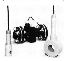
Induktive Leitfähigkeitsmessgeber: Typ 221, links; Typ 222, Mitte; Typ 224, rechts. Für diese Anwendungen sind induktive, d.h. kontaktlose Leitfähigkeitsmesssysteme prädestiniert. Der Messgeber besteht aus zwei ringförmigen, voneinander abgeschirmten Wicklungen, die durch die leitende Lösung elektromagnetisch miteinander gekoppelt sind. Die Primärwicklung wird mit einer konstanten Wechselspannung gespiesen, die induzierte Sekundärspannung ist proportional zum Leitwert der Probe.
