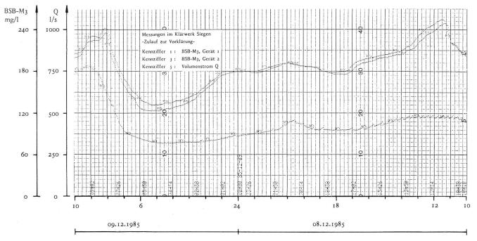
Bild 4. Analysenergebnisse zweier BSB-M3-Geräte bei gleichem Abwasser.
