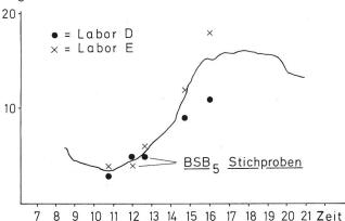
Bild 5. Eichung des BSB-M3 auf den BSB₅ am Auslauf der Nachklärung.
