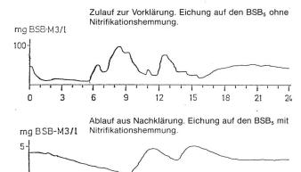
Bild 6. Kontinuierlich gemessene BSB-M3-Konzentrationsganglinie im Zu- und Auslauf der Kläranlage Siegen.
