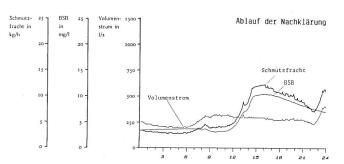
Bild 7. Kontinuierlich gemessene BSB-M3-Konzentrationsganglinie und -Frachtganglinie im Zu- und Auslauf der Kläranlage Siegen.
