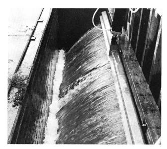
Bild 3. Strömungstechnisch günstiger Austritt des Spülwassers aus dem Kasten. Das Wasser trifft unmittelbar vor Einsetzen der Ausrundung auf die Stirnwand des Beckens.
