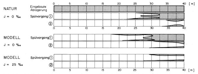
Bild 13. Schematische Darstellung der Verschmutzung vor und nach den Spülungen (Draufsicht). Die Übereinstimmung zwischen Natur und Modell bei J=0% ist offensichtlich.
