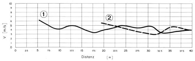
Bild 14. Geschwindigkeitsverlauf der Schwallfront ermittelt aus Schnellbild- und Videoaufnahmen. Die Werte liegen zwischen 3 und 6m/s.
