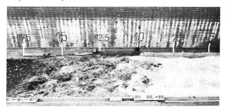
Bild 6. Rund 9m weiter hat sich die Schwallfront etwas abgeflacht; die dunkle Färbung gibt den Bereich an, wo Schmutzpartikel infolge drehender Strömungswalzen aufgewühlt werden. Bereits ist in der rechten Bildhälfte die sogenannte Nachlaufströmung sichtbar.
