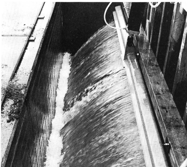
Bild 3. Strömungstechnisch günstiger Austritt des Spülwassers aus dem Kasten. Das Wasser trifft unmittelbar vor Einsetzen der Ausrundung auf die Stirnwall des Beckens.
