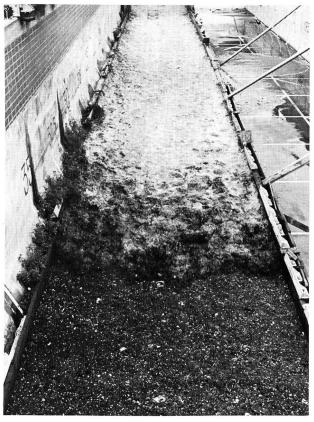
Bild 8. Derselbe Vorgang, wie in Bild 7 gezeigt, aus frontaler Sicht. Obschon die Front bereits ca. 36 m durchmessen hat, bleibt sie symmetrisch und weist eine ausgeprägte Spülkraft auf. Zum Zeitpunkt, wo die Spülfront das Beckenende erreicht hat, ist der Kasten noch zu etwa einem Drittel gefüllt.
