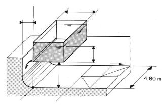
Bild 1. Schematische Darstellung eines Spülkastens. Nach dem Öffnen der Klappe in der Seitenwand entleert sich ein Spülschwall in Richtung des gerundeten Umlenkbleches. Die Breite der Versuchsstrecke betrug 4 80 m
