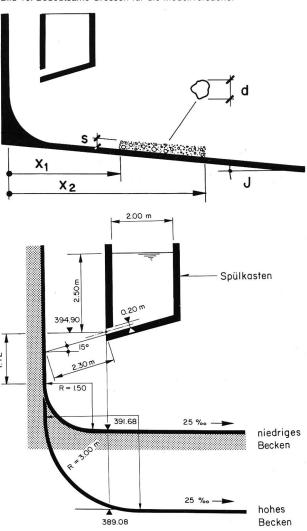
Bild 11. Abmessungen der optimalen Variante; Fallstudie, Längsschnitt.
