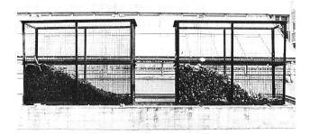
Bild 2. Versuchsanordnung zur Erfassung von Komposteluaten. Links: zerkleinerte Garten- und Küchenabfälle, rechts: zerkleinerte Siedlungsabfälle (Kehricht).
