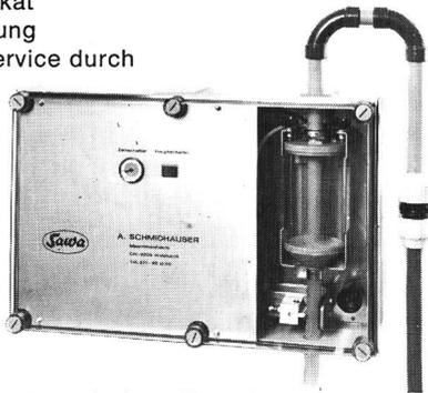
zur vollständig automatischen Entnahme von Abwasserproben in Kläranlagen und Industrie zeit- oder mengenproportionale Entnahme mit Einfrierschutz und Rückspülung. Anschlussfertig.
