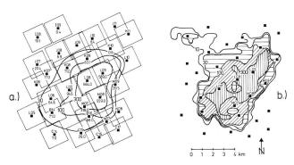
Bild 3. Der Hagelfall vom 1. Juni 1978 im Napfgebiet zeigt eine gute Übereinstimmung zwischen Hageldetektoren (links) und Radardaten (rechts). Vierecke zeigen Standorte der Hageldetektoren, die Isolinien die Energiewerte in Joule/m² (nach *Waldvogel*).
