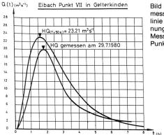
Bild 4. Beispiel einer gemessenen Abflussganglinie und ihre Nachrechnung (Analyse) für die Messstation Eibach Punkt VII in Gelterkinden.
