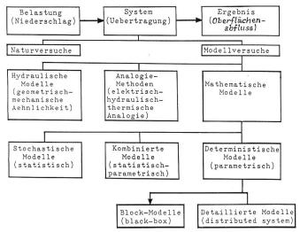
Bild 2. Einordnung der Hochwasserabschätzmethode in der Modell-übersicht.
