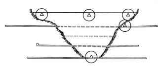
Bild 6. Geplante Anlageinstrumentierung der Bogenmauer Mauvoisin.
