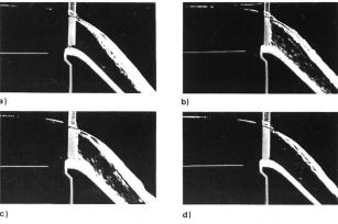
Bild 6. Halterungsstange Typ 2, 3, 4 über der Wehrkrone bei Q = 150 I/s.
