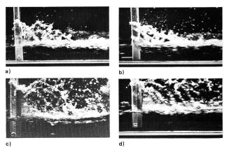
Bild 8. Halterungsstange Typ 6 und 7 sowie Prototypen im Abfluss mit parallelen Stromlinien,  $Q=150~{\rm l/s}.$
