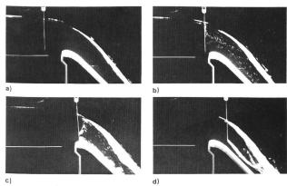
Bild 3. Der Einfluss einer in verschiedenen Lagen eingetauchten Stechpegelspitze auf den Abfluss und den Lufteintrag über einen Standard-überfall. Q = 150 l/s.
