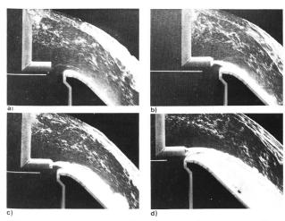
Bild 4. Der Einfluss eines in verschiedenen Lagen eingetauchten, L-förmigen Rohres auf den Abfluss und die Wirbelbildung über einen Standardüberfall,  $Q=150~\mathrm{I/s}$ .
