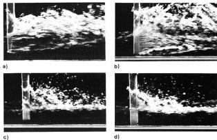
Bild 7. Halterungsstange Typ 1, 5, 2, 4 in Abfluss mit parallelen Stromlinien, Q = 150 l/s.
