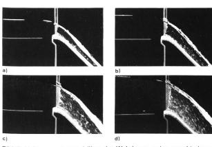
Bild 5. Halterungsstange 1 über der Wehrkrone unter verschiedenem Durchfluss,  $\triangle Q = 50$  l/s.
