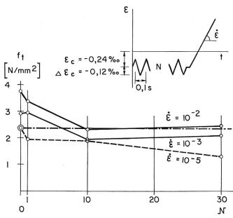
Bild 4. Zugfestigkeit von Normalbeton (Grösstkorn 32 mm) in Abhängigkeit der Druckvorgeschichte (W Druckzyklen von je 0,1 Sekunde Dauer) und der Dehngeschwindigkeit (¿ pro Sekunde).
