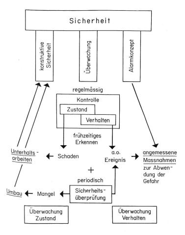
Bild 2. Sicherheitskonzept für Talsperren und Aufgaben der Überwachung.
