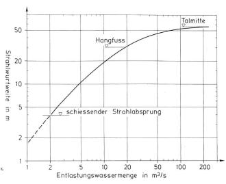
Bild 7. Sprungweite des Wurfstrahles in Abhängigkeit des Entlastungsabflusses.
