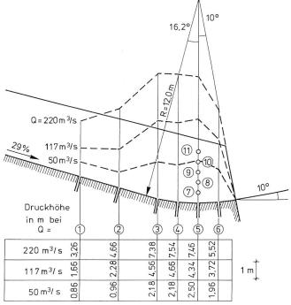
Schussrinne entscheidend vermindert. Weil der rechte Talhang dem Strahl des Mauerüberfalls ausgesetzt und dadurch gefährdet worden wäre, erhielt der Trennpfeiler in einem letzten Verbesserungsschritt einen Ansatz über der Mauerkrone.
