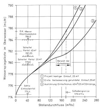
Bild 3. Hydraulische Charakteristik des Bauumleitstollens.
