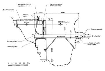
Bild 8. Längsschnitt durch den Entnahmeturm und die Rohrbrücke.
