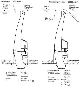
Bild 6. Kapazität der Hochwasserentlastungsorgane bei Normalstau und Bemessungsüberstau.
