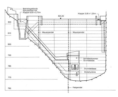
Bild 4, links. Querschnitt durch die Staumauer Solis mit Grundablass und Schieberkammer, Dotierturbine, Kontrollgang, Mauer- und Felspendel.
