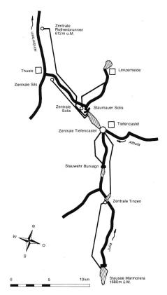
Bild 1. Die Kraftwerkgruppe Mittelbünden des Elektrizitätswerkes der Stadt Zürich nutzt die Wasserkräfte des Flusses Julia ab Kote 1680 m ü. M. und der Albula ab deren Zusammenfluss. Die Wasserrückgabe erfolgt in den Hinterrhein in Rothenbrunnen auf Kote 612 m ü. M.
