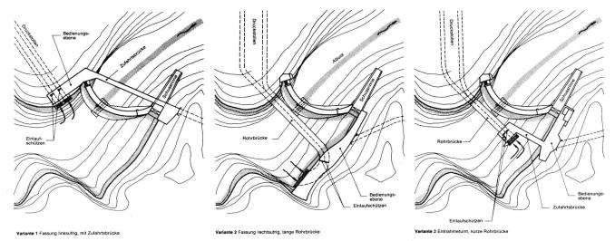
Bild 7. Variantenstudien Triebwasserfassung.
