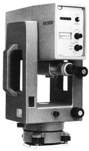
Das Helium-Laserlicht als Strahlungsquelle und ein einziger Kristall zur Modulation und Demodulation des Lichtes steigern die Genauigkeit auf ± (0,2 mm + 0,2 mm/km)! Das 11 kg leichte Gerät ist damit bereits bei Distanzen über 200 m dem Sekundentheodolit zur Punktbestimmung überlegen.
