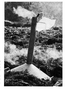
Bild 6. Biofilter aus Fastertorf und Heidekraut zur Reinigung der Abluft aus der Schlammtrocknungsanlage. Entnahme der Geruchsproben über einem Trichter von 1 m² Grundfläche
