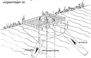
Im Zugersee ist nach EAWAG-Bericht (Imboden) die volle Aerobie nur möglich mit Sauerstoffeintrag und Zirkulationshilfe (SE + ZH). Damit wird das P-Ziel 30 mg/m³ bis etwa im Jahre 2006 seeintern gelöst. Hingegen würde bei der Variante Tiefenwasserableitung TWA (Stollen) ab zirka 100 bis 200 m Tiefe Anaerobie herrschen.
