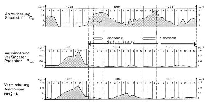
Bild 2. Der Hüttnersee im Kanton Zürich wurde mit dem System «Bergbach» seit Ende 1983 belüftet und umgewälzt. Die Messwerte am Seegrund, das heisst in 12 m Tiefe, wurden vom kantonalen Laboratorium Zürich erhoben und ausgewertet. Sie zeigen die Sauerstoffanreicherung, die Verminderung des verfügbaren Phosphors und die Verminderung des Ammoniums im Seewasser.
