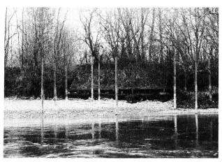
Bild 2. Zeugen der Ufererosion. Die ehemals bodenbündigen Betonsockel der Panzersperre oberhalb Rheinklingen wurden in Ufernähe freigespült und ragen heute, nach etwa 40 Jahren, 40 bis 50 cm aus der Kiesbank heraus.
