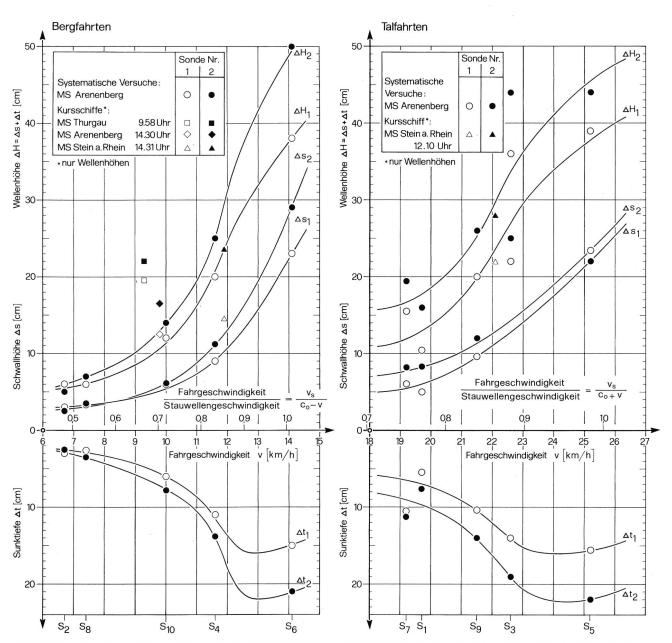
Bild 8. Wellenhöhen, Schwallhöhen und Sunktiefen in Abhängigkeit der Fahrgeschwindigkeit des Fahrgastschiffes «Arenenberg», systematische Messungen vom 30. Juli 1984 unterhalb St. Katharinental. Rheinabfluss etwa 450 m³/s.
