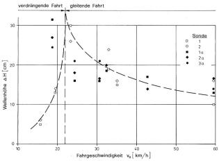
Bild 10. Wellenhöhen in Abhängigkeit der Fahrgeschwindigkeit des Polizeibootes TG 4; oben: Bergfahrten, unten: Talfahrten.
