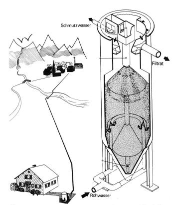
Bild 1, links. Das Abwasserentsorgungssystem Econex von Häny & Cie. AG ist für Liegenschaften mit grosser Anschlussdistanz oder grosser Förderhöhe kostengünstig.
