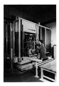
Servohydraulische Triaxialprüfeinrichtung mit auf Arbeitsposition eingefahrener Hochdruckzelle für mehrachsige Belastungen bei erhöhten Temperaturen.
