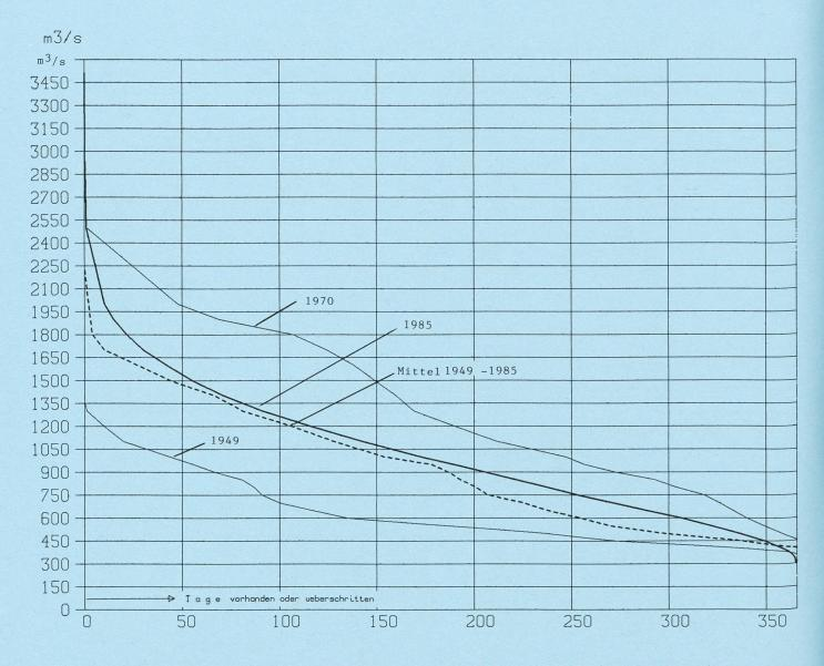
Abflussmengen des Rheins bei Rheinfelden. Oben Ganglinien, unten Dauerkurven. Einzugsgebiet 34550 km², Vergletscherung 1,6%, Jahresabflussmenge 1935–1985 1035 m³/s, Jahr 1985 939 m³/s.
