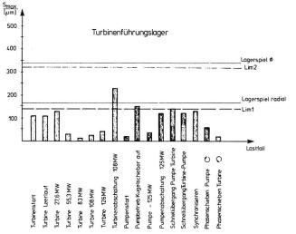
Bild 8. Schwingwege bei unterschiedlichen Betriebszuständen.
