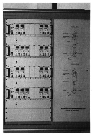
Bild 7. Ansicht der Schwingungsmessanlage der Maschinen 1 und 2 der Anlage Kühtai. Rechts sind die Anordnungen der Messaufnehmer dargestellt.
