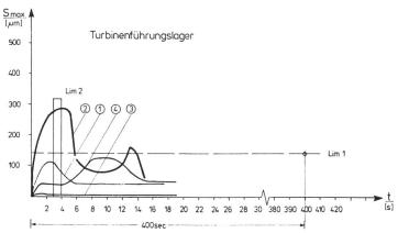
Bild 9. Zeitliche Verläufe der Wellenschwingung bei verschiedenen Betriebszuständen.
