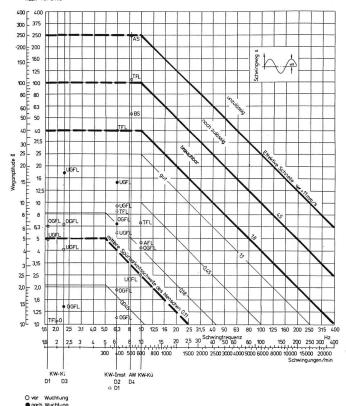
Bild 11. Übersicht über Lagerschwingungswerte in Kraftwerken der Tiroler Wasserkraftwerke Aktiengesellschaft, Innsbruck.
