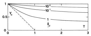
Bild 3. Zeitliche Lage des Punktes D nach Bild 1,  $Y_0(T)$ , mit  $Y_0 = h_0/H$  für verschiedene, typische Werte von  $\sigma$ .
