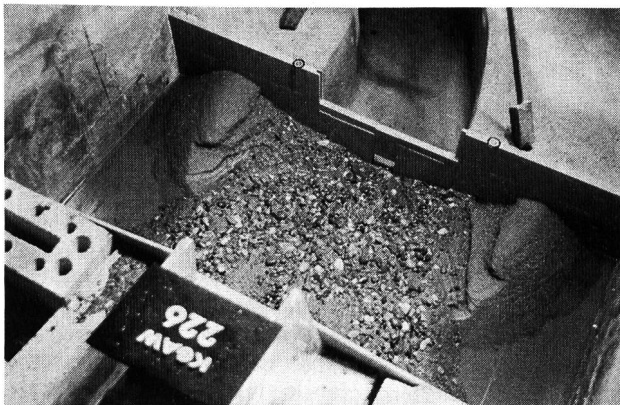
Bild 4. Endstadium des Modellversuches 226: Bei sehr kurzen und breiten Ablagerungsplätzen entstehen nur bescheidene Ablagerungen mit dünenartigen Pyramiden aus Feinmaterial an den Stellen der seitlichen Wasserwalzen. Fließrichtung von unten nach oben.
