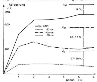
Bild 6. Die Füllung von drei Ablagerungsplätzen im Verlauf von sechs aufeinanderfolgenden Hochwasserwellen (HQ) bei gleicher Beckenbreite (100cm) und verschiedener Länge (50, 100 und 150cm). V50, V100, V150 = maximale Speichervolumina für die drei Becken (50, 100 und 150cm). Geschiebefracht iedes Ereignisses 170I.
