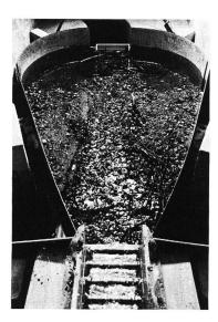
Bild 9. Birnenförmiger Ablagerungsplatz (Stiel nach oben) im Modellversuch. Fliessrichtung des Wassers im Bild von unten nach oben.
