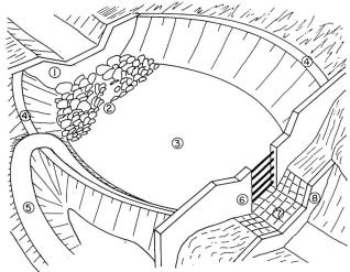
Bild 1. Geschiebeablagerungsplatz mit seinen Teilen: 1 Einlaufbauwerk, 2 Kolksicherung, 3 Ablagerungsplatz, 4 Umfassungsdämme, 5 Zufahrt-strasse (Leerung), 6 Rückhaltebauwerk, 7 Kolksicherung, 8 Gegensperre.
