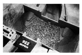
Bild 4. Endstadium des Modellversuches 226: Bei sehr kurzen und breiten Ablagerungsplätzen entstehen nur bescheidene Ablagerungen mit dünenartigen Pyramiden aus Feinmaterial an den Stellen der seitlichen Wasserwalzen. Fliessrichtung von unten nach oben.
