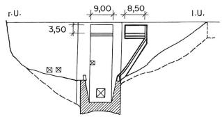
Bild 2. Staumauer Egschi (Safiental, GR). Der 1984 erstellte 8,5 m breite zusätzliche Hochwasserüberfall ist neben dem ursprünglichen, 9 m breiten Überfall angeordnet.
