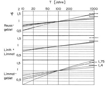
Bild 5. Statistisch ermittelte Verhältniszahlen  $\phi_T = HQ_T: HQ_{100}$  für Abflussmessstationen der Flussgebiete Reuss, Linth und Limmat. (——Wahrscheinliche Schätzwerte, ————noch vertretbare Schätzwerte für den Stausee Innertal der Kraftwerke Wägital.)
