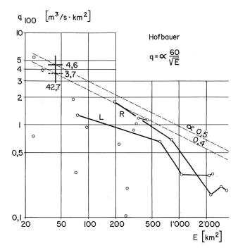
Bild 4. Statistisch ermittelte 100jährliche Spitzenabflüsse bei den Abflussmessstationen der Flussgebiete Reuss (R) und Limmat (L). Schätzwerte für den Stausee Innertal der Kraftwerke Wägital (4,6 m³/s·km² wahrscheinlicher und 3,7 m³/s·km² tieferer Schätzwert).
