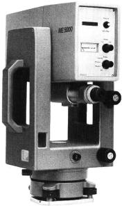
Das Helium-Laserlicht als Strahlungsquelle und ein einziger Kristall zur Modulation und Demodulation des Lichtes steigern die Genauigkeit auf ± (0,2 mm + 0,2 mm/km)! Das 11 kg leichte Gerät ist damit bereits bei Distanzen über 200 m dem Sekundentheodolit zur Punktbestimmung überlegen.
