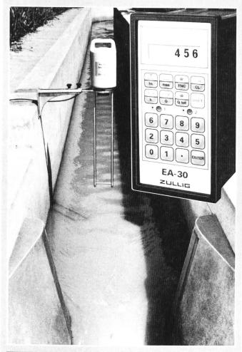
Referenz-Echolot Störfaktoren selbstkompensierend (Hohe Sendefrequenz, Auflösung  $\pm\,1\,$  mm)
