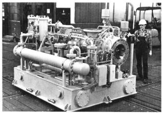
Kompressorgruppe Uniturbo 34 einer Unitop-Wärmepumpe in der Fernheizzentrale Gäyle-Karskär. Schweden.
