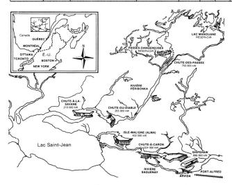
Figure 2. Le bassin hydrographique du Saguenay avec les 6 centrales d'Alcan, puissance installée 2687 MW.
