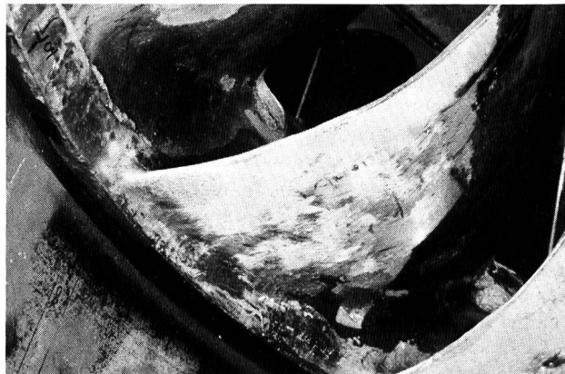
Figure 4. Roue turbine Francis, sortie d'aube réparée.
