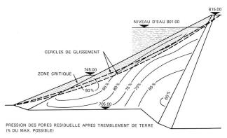
Figure 12. **Pueblo Viejo:** pression des pores induite par le séisme et surfaces critiques de glissement.
