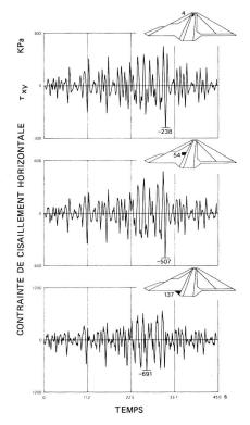
Figure 10. **Pueblo Viejo:** évolution de la contrainte de cisaillement horizontale induite, dans 3 éléments du réseau discret.
