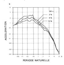
Figure 5. Spectre de réponse dû à l'accélérogramme artificiel utilisé pour l'analyse de **Pueblo Vieio.**
