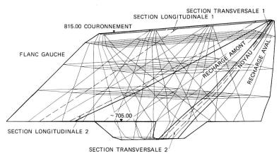
Figure 7. **Pueblo Viejo:** vue perspective du modèle tridimensionnel de la digue.
