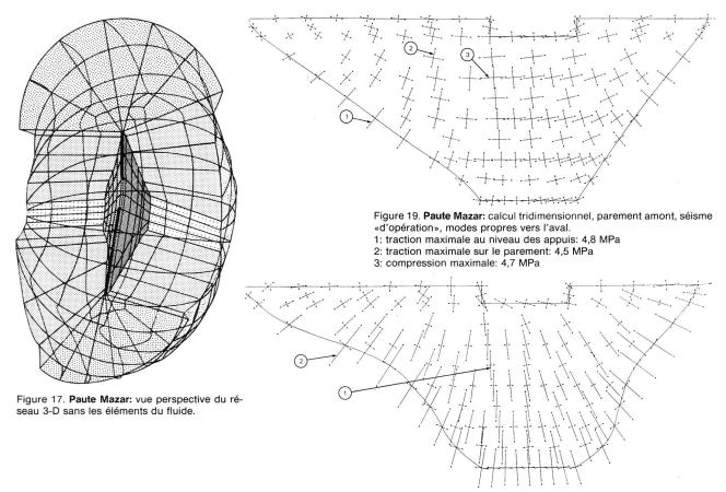
Figure 20. **Paute Mazar:** calcul tridimensionnel, parement aval, séisme «d'opération», modes propres vers l'aval.
