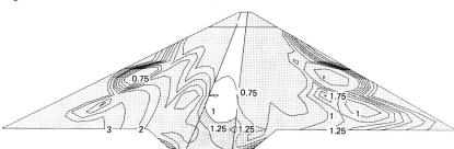
Figure 8. **Pueblo Viejo:** rapport entre la charge hydrostatique et la contrainte principale c2 (modèle tridimensionnel).
