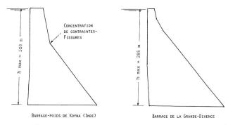
Figure 3. Coupe en travers typique de deux barrages-poids.
