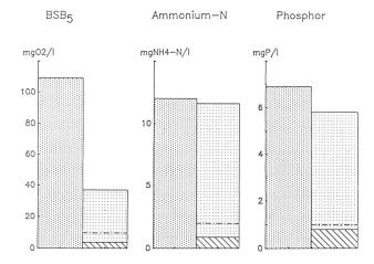
Reinigungsleistung (berechnet aus ersten Probenahmen)
