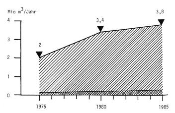
Bild 2. Klärschlammanfall 1975 bis 1985. Die Zunahme der Schlammenge (TS) und der angeschlossenen Einwohnergleichwerte (EGW) stimmen nicht überein. Die Gründe dafür sind die Einführung der Phosphatfällung, die Zunahme der spezifischen Schmutzfrachten und die Verbesserung des Wirkungsgrades der ARA (Seite 45).
