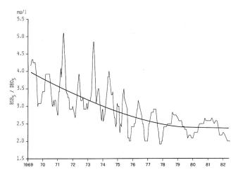
Bild 1. Abnahme des Sauerstoffbedarfs (BSB<sub>5</sub>) infolge der Abwassersanierung. Aare bei Felsenau (Koblenz AG), bei der Mündung in den Rhein (Seite 30)
