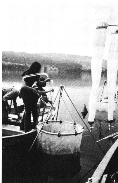
Bild 3, Mitte. Die Planktonorganismen verhalten sich im Laborexperiment anders als im freien See. Man versucht deshalb, die Seeverhältnisse in sog. «Corralls» möglichst unverändert zu halten und nur das zu ändern, dessen Wirkung man prüfen will. Unser Bild: Probenahme aus einem Versuchscorrall auf dem Greifensee.
