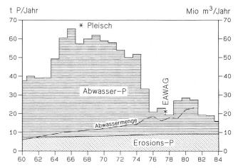
Bild 5. Die Belastung des Greifensees mit Phosphor von 1960 bis 1984. Berechnungsbasis: Umfassende Zuflussuntersuchung 1977/78, Zuflussuntersuchung 1968 (*Pleisch* 1970), Analysen und Abflussmessungen in den Kläranlagen, Schätzung (Interpolation) des landwirtschaftlichen Anteils. Die Werte von 1968 und nach 1978 sind extrapoliert.
