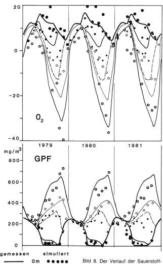
Bild 8. Der Verlauf der Sauerstoffkonzentration (inkl. O<sub>2</sub>-Äquivalente der oxidierbaren Stoffe, O<sub>2</sub>) und des gelösten Gesamtphosphors (GPF) in Simulation und Realität. Punkte: Simuliert. Linien: Gemessen.
