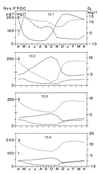
Bild 10. Der Verlauf der Wasserqualität des Seeabflusses (Glatt) 10.1: Ohne Sanierungsmassnahmen, bei einer Jahresbelastung von 20 t P 10.2: Mit Tiefenwasserableitung 4 m³/s, P-Belastung 20 t
