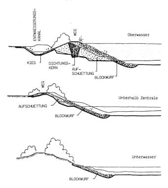
Bild 3. Normalprofile der Hochwasserdämme.
