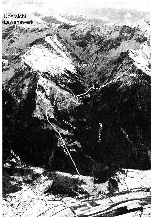
Bild 3. Übersicht über das Lawenawerk. F = Fassungen Lawena, ca. 1400 m ü.M.; W = Wasserschloss und Apparatekammer, 1380 m ü.M.; M = Maschinenhaus, 500 m ü.M.; OOOO Einzugsgebiet.
