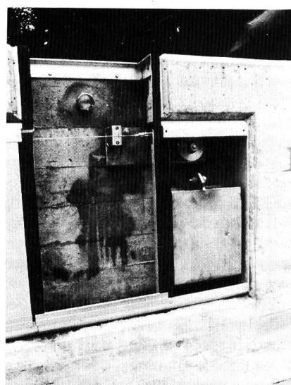
Bild 2b, rechts. Bewegliche Alignementdrahtaufhängung mit Dehnungsausgleich und Spanngewicht.
