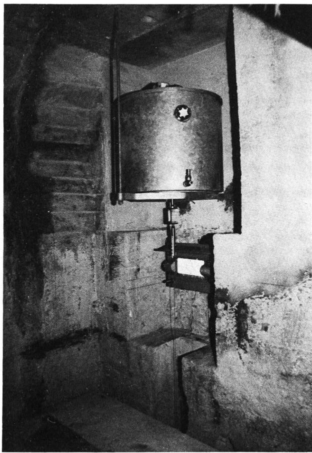
Bild 1. Installation eines Schwimmlots. Um den Schwimmertank und die Setzplatte für das Messgerät unterbringen zu können, musste die vorhandene Nische in der Staumauer erheblich vergrössert werden.
