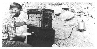
Echos aus dem Erdinnern: Dieser Seismograph zeichnet die sehr schwachen Bebenwellen auf, die durch künstliche Erschütterungen – Sprengungen oder Vibratoren – ausgelöst werden.
