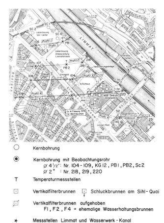
Bild 3. Situation 1:7500 mit Darstellung der Bohrungen, Messstellen und Profilspuren.
