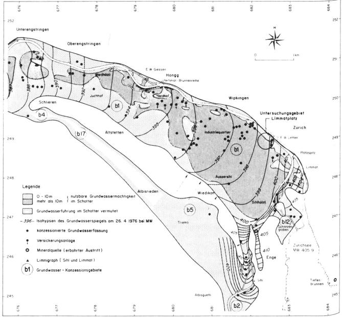
Bild 1. Grundwasserkarte 1:50000 des Limmattales zwischen Zürich und Unterengstringen.
