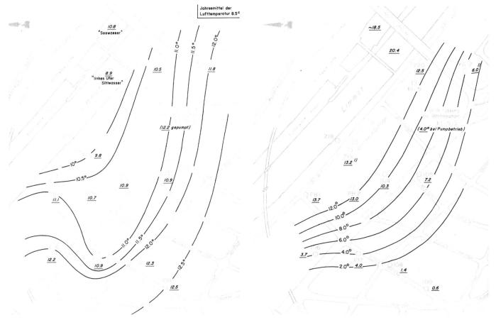
Bild 10. Isolinien der Jahresmittelwerte der Grundwassertemperatur in 7 m Tiefe unter Terrain in der Zeit von November 1980 bis Oktober 1981, ohne Rückversicherung.
