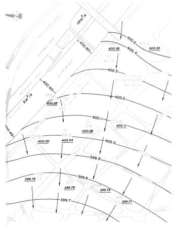
Bild 4. Isohypsen des Grundwasserspiegels am 1. Juni 1983 bei Ruhelage (hoher Mittelwasserstand). Massstab 1:5000.
