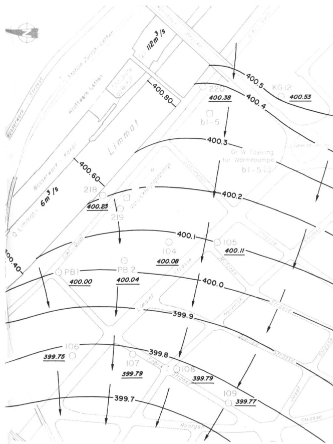
Bild 4. Isohypsen des Grundwasserspiegels am 1. Juni 1983 bei Ruhelage (hoher Mittelwasserstand). Massstab 1:5000.
