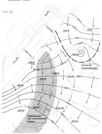
brunnen. Es handelt sich um ein 50 m langes, in 3 m Tiefe unter Terrain verlegtes Sickerrohr mit 2‰ Längsgefälle, welches an seinem nordwestlichen Ende in einen 12 m tiefen vertikalen Schluckbrunnen mündet. Anlässlich eines Probelaufes wurde beobachtet, dass bei einer Rückgabemenge von rund 2500 l/min alles Wasser bereits in der horizontalen Filterstrecke versickerte, ohne den Schluckbrunnen zu erreichen.
