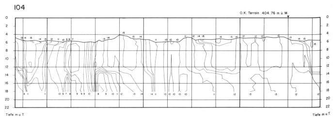
Bild 9. Isoplethen der Grundwassertemperatur bei den Messstellen PB 2 und 104.
